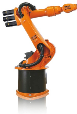
Figura 1: Imatge d'un braç robòtic (tipus de manipulador sèrie) [1]
