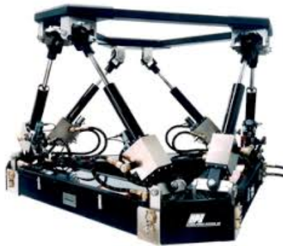
Figura 2: Manipulador Stewart-Gough (tipus de manipulador paral·lel) [2]
