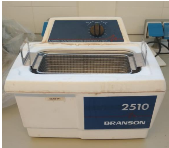
Figura 5. Equip d'ultrasons. Branson 2510 42kHz.
