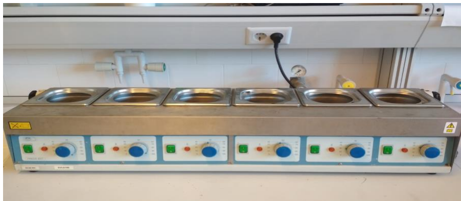
Figura 4. Bany d'aigua amb resistències calorífiques, Selecta
