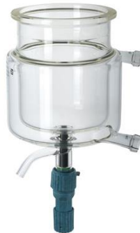
Figura 8-2. Recipiente de reacción LR 2000.2
