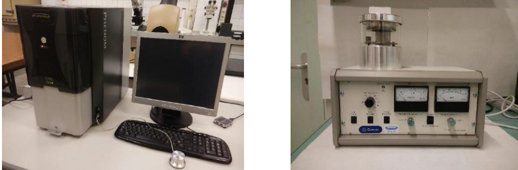
Figura 2-19. Microscopio electrónico de barrido (Phenom Standard) y equipo de recubrimiento (SC7620, Quorum Technologies)
