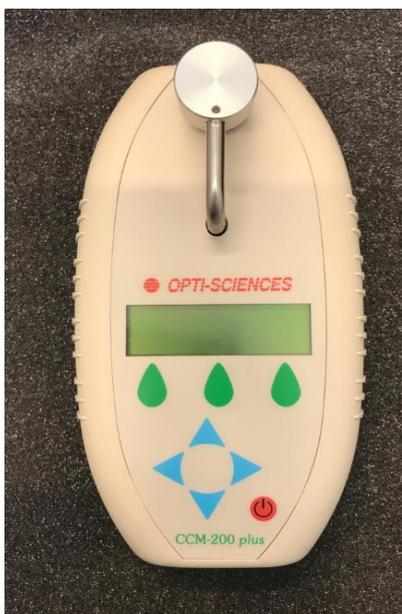
Figura 3-7. OPTI-SCIENCES CCM-200 plus utilizado para la medición de las clorofilas.
