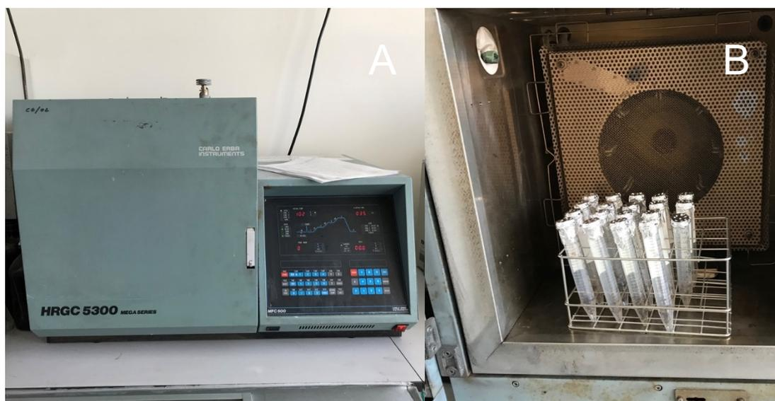
Figura 3-8. Estufa HRGC 5300 (A) empleada en la desecación de las muestras (B).
