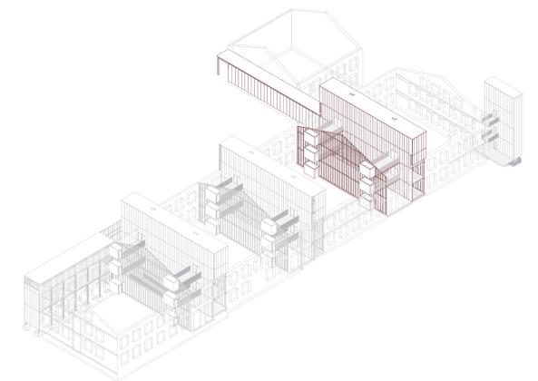
1. La envolvente que cierra la cara sur del patio está resuelta con doble policarbonato transparente de 22mm + cámara de aire. La exposición es noreste, por lo que no recibirá radiación solar directa. Se integran a la envolvente dos vestíbulos con dos entradas en cada planta para flexibilizar la compartimentación de cada tramo de nave. Los accesos se prevén como elementos exteriores pero cubiertos, a modo de prevestíbulo.
