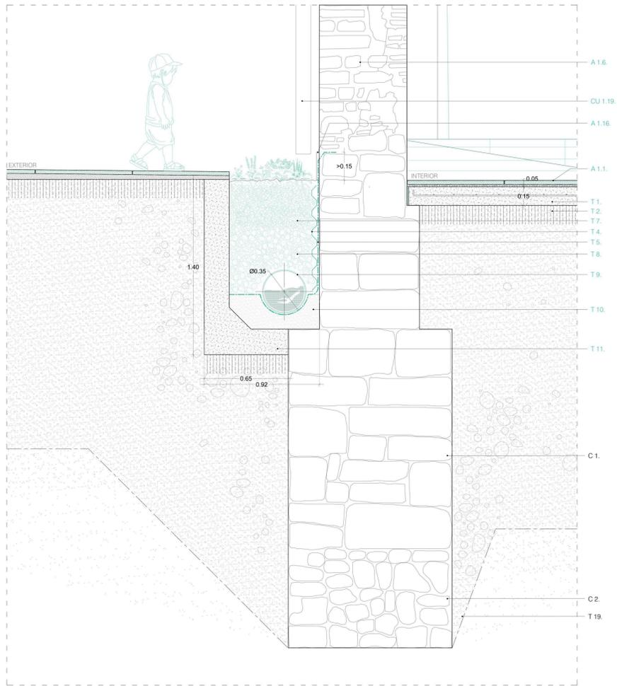
**DET I.1:** sección vertical de los pozos de drenaje de las bajantes de las aguas pluviales de la cubierta de la nave principal.
