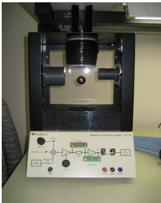
Figura 5. Levitador magnético de Feedback Instruments Ltd.
