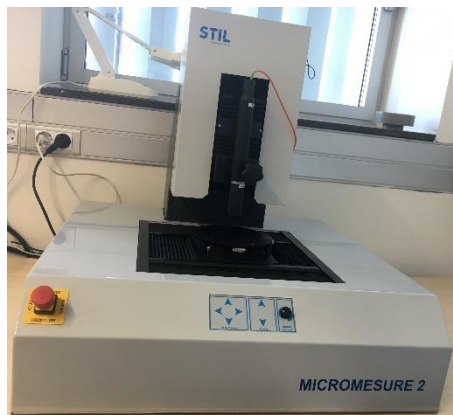
Figura 3.2. Fotografia del perfilòmetre òptic 3D MICROMESURE 2
