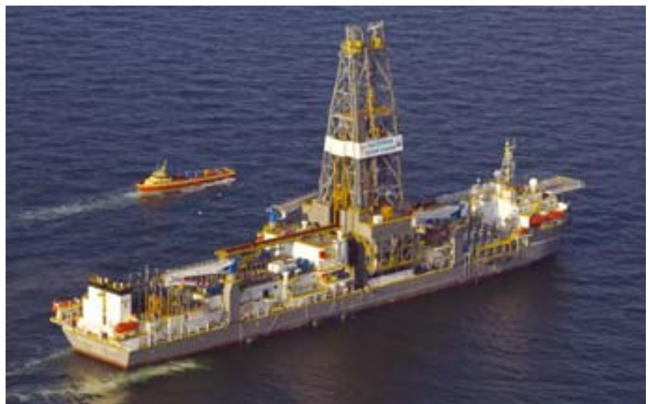
> El "Discoverer Clear Leader", operado por Transocean es uno de los buques perforadores más avanzados del mundo con capacidad de perforar en profundidades de hasta 12.000 pies.
