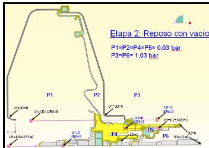
Fig.11 – Condiciones de contorno y cargas. Etapa 2
