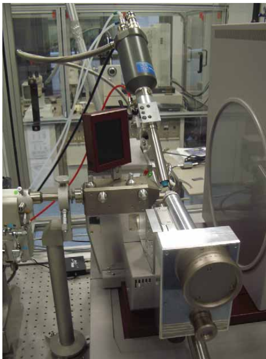
Figura 3 - La difracción de los cristales por los rayos X puede realizarse en un difractómetro convencional o mediante la radiación sincrotrónica mucho más potente..
