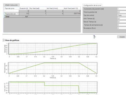
Figura 11. Detalle del editor de patrones de movimiento para el caso trapezoidal avanzado (Fuente: MST de Omron)
