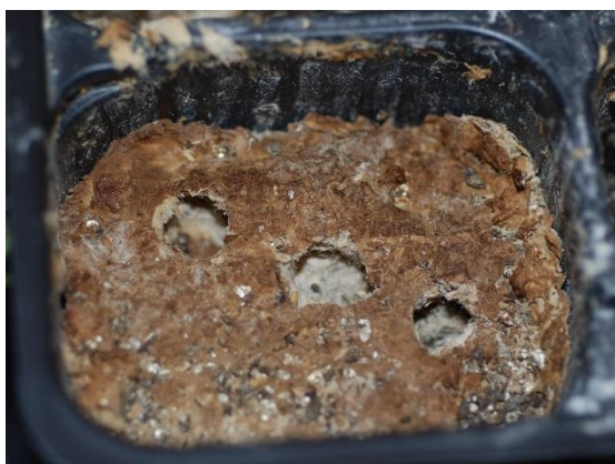
Il·lustració 28. Hydromulch on s'ha mesurat la força necessària per penetrar-lo. Font: Pròpia
