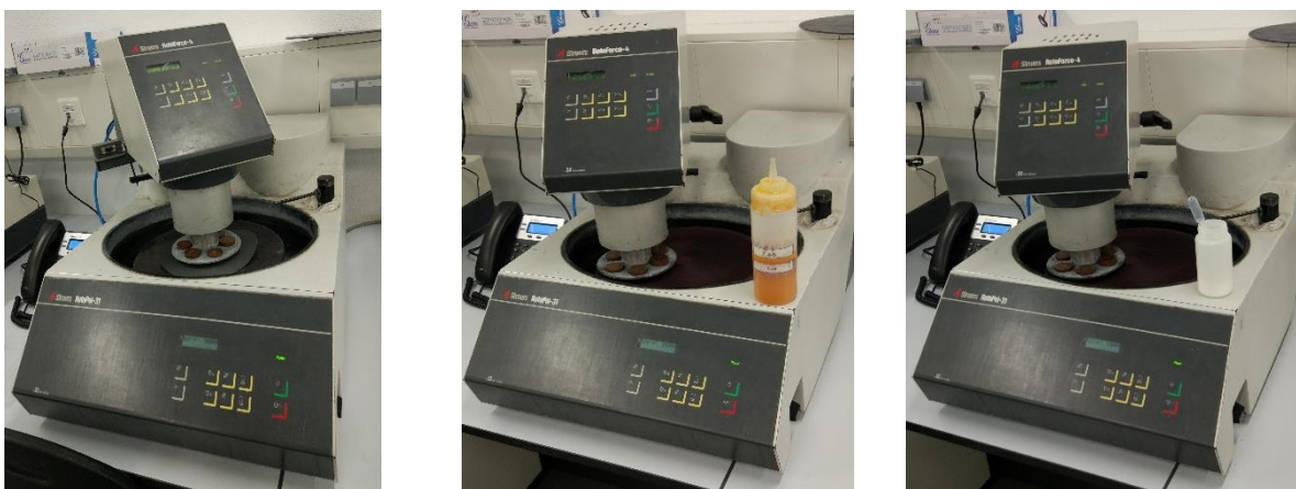
Fig. 3.10. Procediment de polit ordenat d'esquerra a dreta
