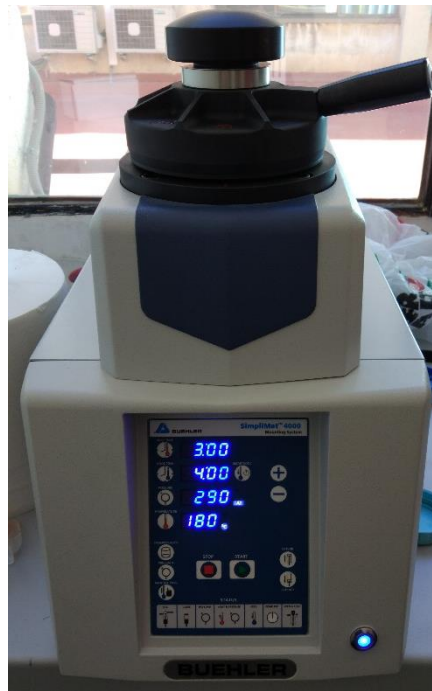
Fig. 3.9. Paràmetres per muntar la baquelita
