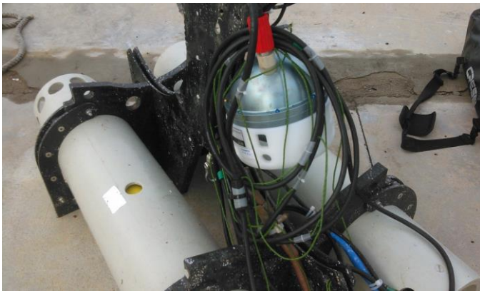
Figura 3 Prototipo de OBS cableado preparado en muelle
