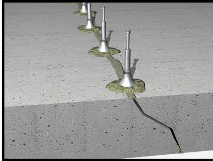
**Figura 5.6** Colocación de inyectores. (CYPE ingenieros S.A., 2017)
