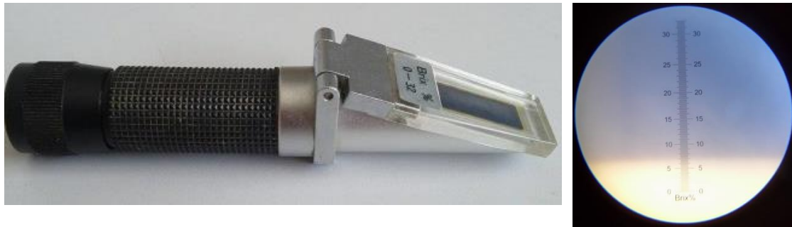
Figura G. Refractómetro, a la izquierda. Ejemplo de medición de °Brix, a la derecha. Fuente: propia.
