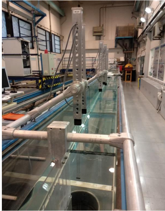
FIGURA 17: foto dels sensors HRWallingford disposats al llarg del canal
