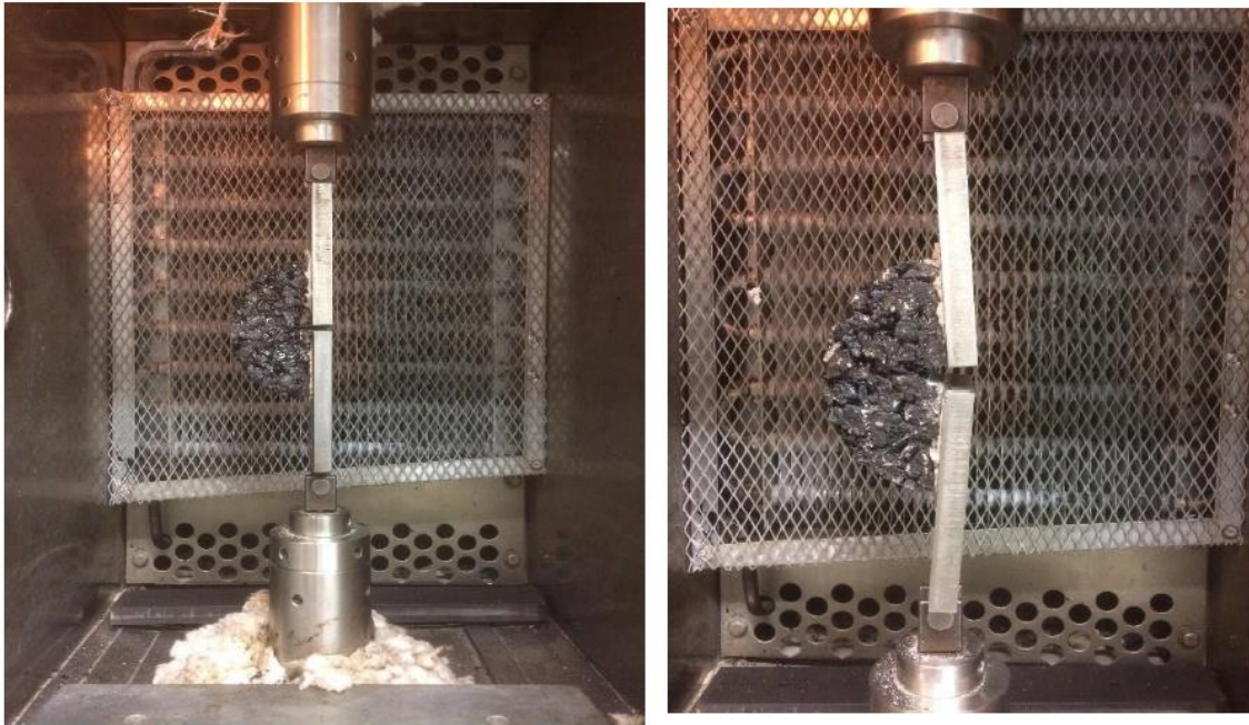
Figura 45: El antes y después de la prensa del ensayo Fénix, se aprecia la fisuración y ductilidad
