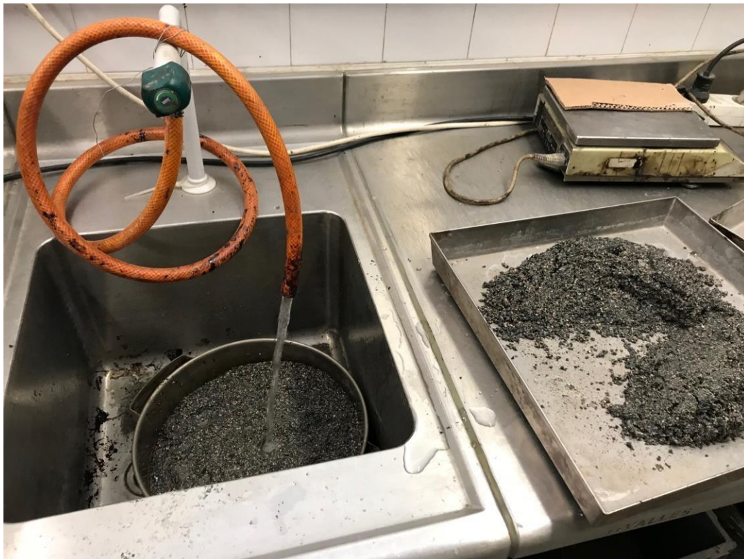
Figura 23: Limpieza del filler calizo de recuperación, fracción 0.063 lavado con agua
