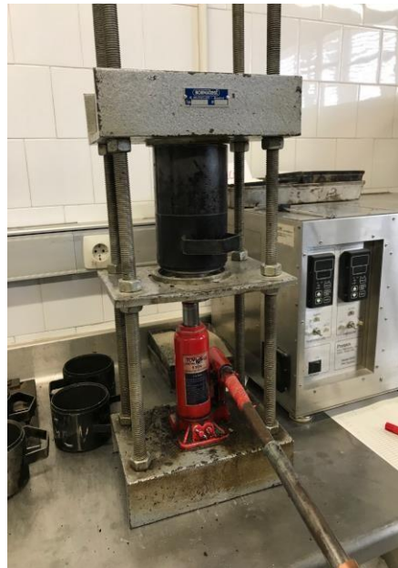
Figura 37: Mecanismo desmolde probetas
