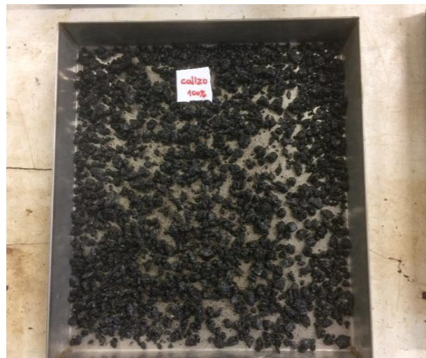
Figura 13: Probeta desmenuzada manualmente
