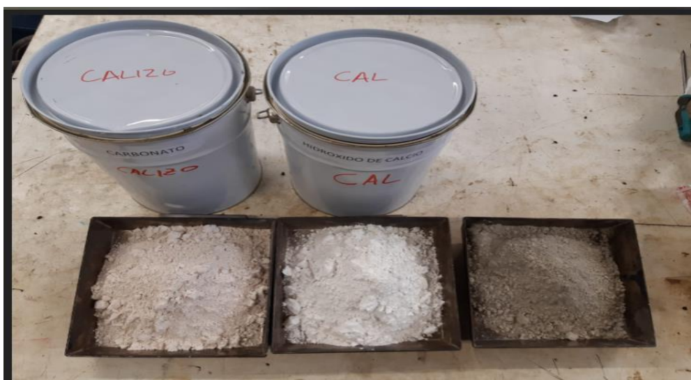
Figura 5: Filler de aportación: Calizo, cal y cemento
