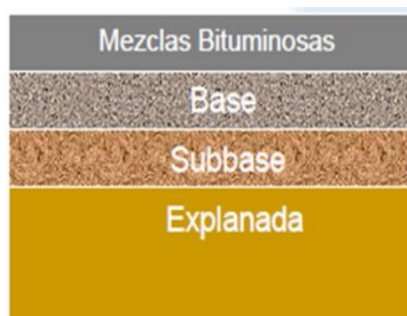
Figura 1: Estructura de un firme flexible o semirrígido.
