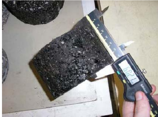
Figura 39: Medición de probetas con pie de rey
