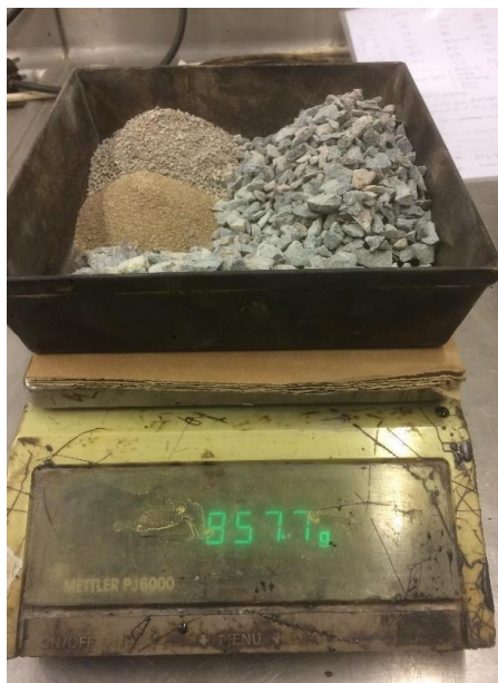
Figura 25: Pesado árido grueso y finos, a falta del filler de aportación (42,3 gr)
