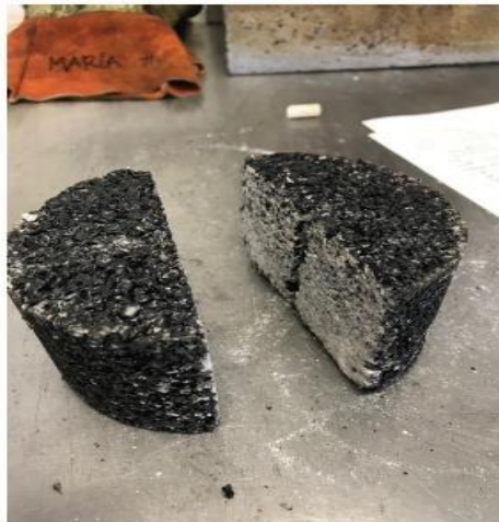
Figura 41: Probeta cortada para el ensayo Fénix
