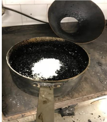
Figura 31: Adición filler en el proceso de mezclado
