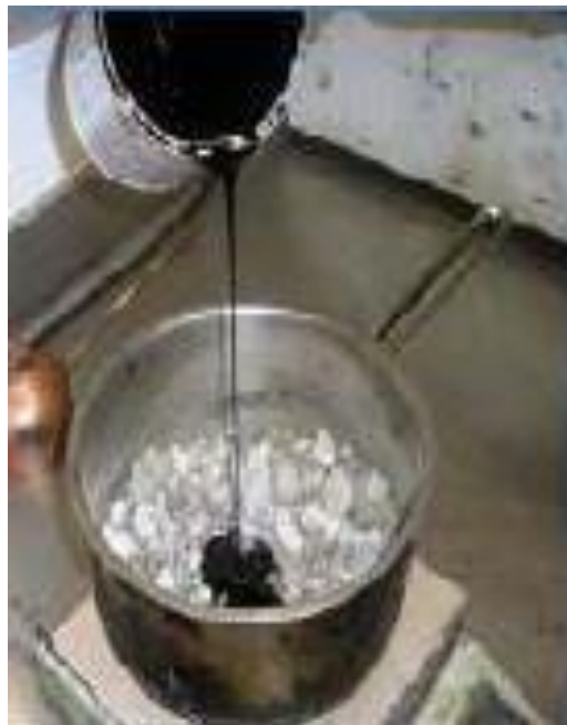
Figura 30: Vertido betún sobre áridos
