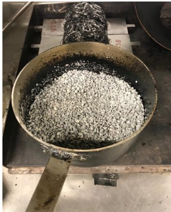
Figura 29: Mezclado en seco de los áridos
