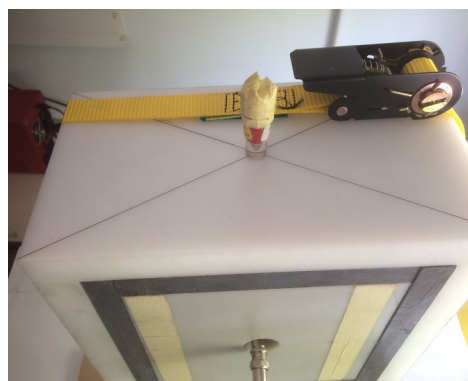
Imagen 9: Posicionamiento de la fuente para el detector con convertor de Plomo
