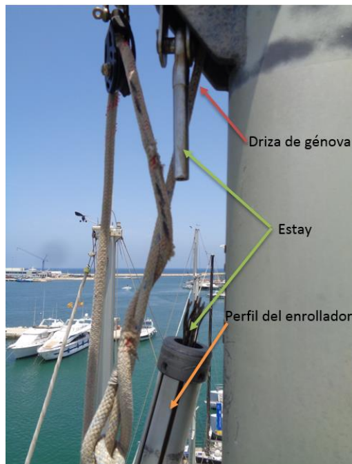
Ilustración 92. Estay del enrollador partido. Fuente: Propia
