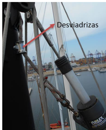
Ilustración 94. Desviadrizas instalado en la driza de génova. Fuente: Propia
