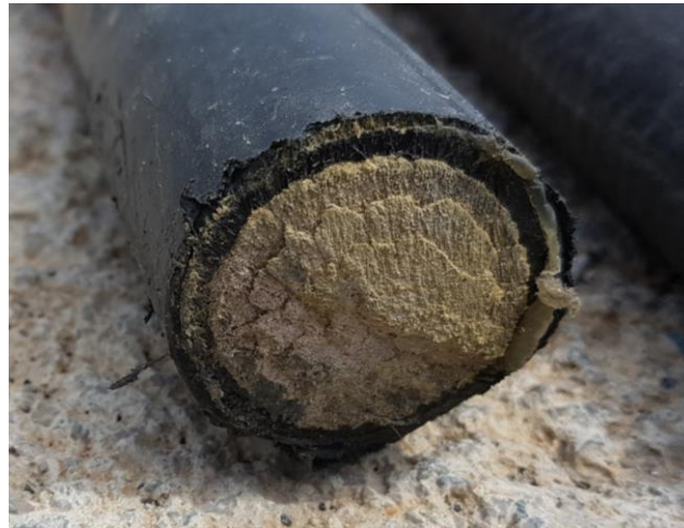
Ilustración 62. Sección de PBO. Fuente: Propia
