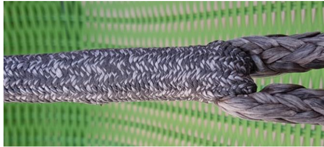
Ilustración 65. Funda de un cabo de Dyneema. Fuente: Propia
