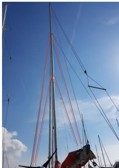
Ilustración 7. Palo de monocasco sin crucetas. Fuente: Propia
