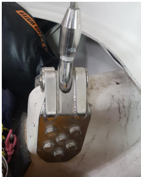
Ilustración 26. Anclaje del cadenote en la cuaderna maestra. Fuente: Propia
