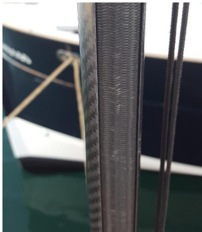
Ilustración 69. Cable de carbono composite con protector. Fuente: Propia
