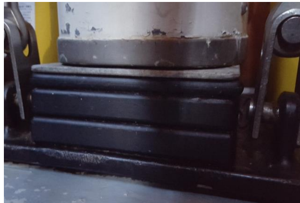
Ilustración 44. Placas situadas entre la carlinga y la coz. Fuente: Propia
