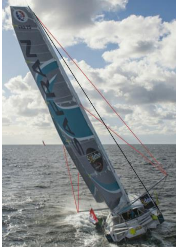
Ilustración 22. Outriggers del Imoca 60 Safran. Fuente: Vincent Curutchet
