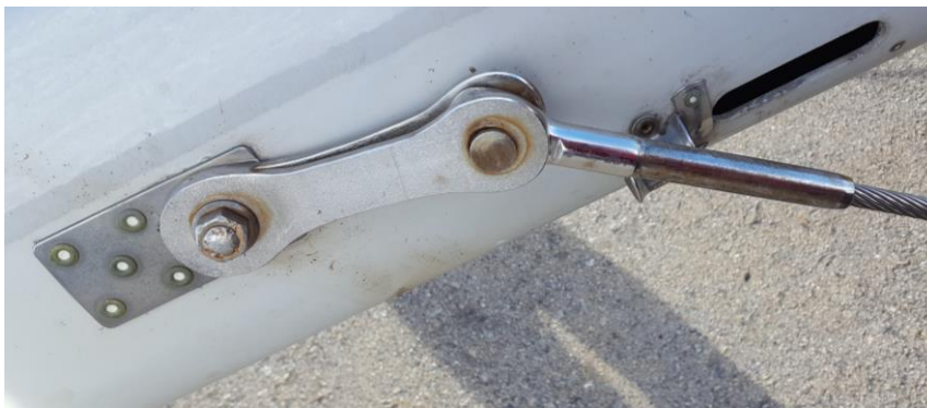
Ilustración 29. Anclaje en un palo de aluminio. Fuente: Propia
