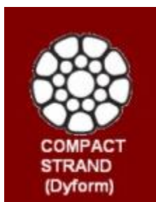
Ilustración 54. Sección de Dyform. Fuente: CdP Jarcias
