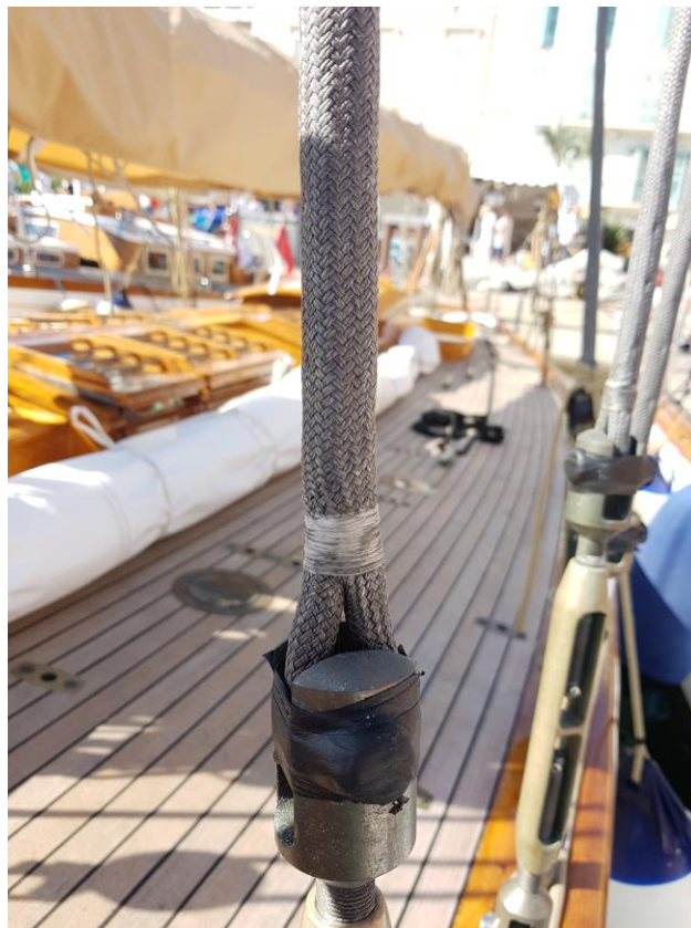
Ilustración 66. Jarcia transversal de Dyneema. Fuente: Propia
