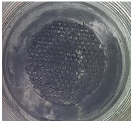
Ilustración 100. Vista del interior del terminal, jarcia de ECsix. Fuente: Propia
