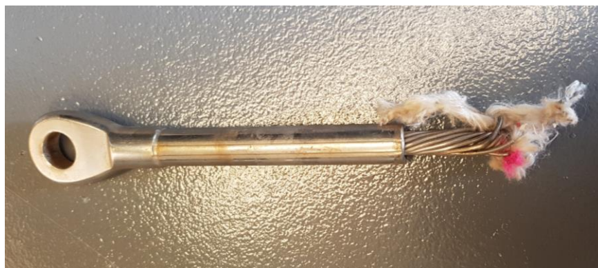
Ilustración 91. Parte superior del estay partido por una driza. Fuente: Propia
