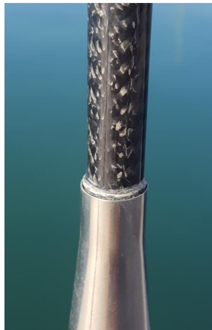
Ilustración 111. Unión terminal con jarcia de carbono compacto. Fuente: Propia
