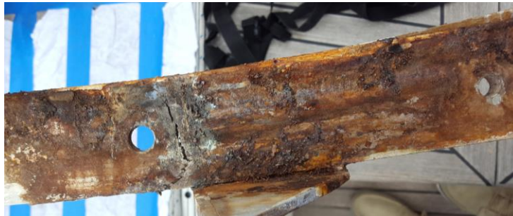
Ilustración 115. Parte posterior del cadenote. Fuente: Propia
