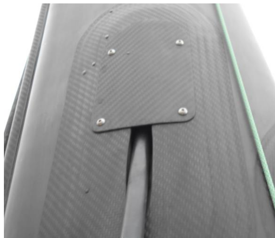
Ilustración 107. Unión del obenque alto con el palo. Fuente: Propia
