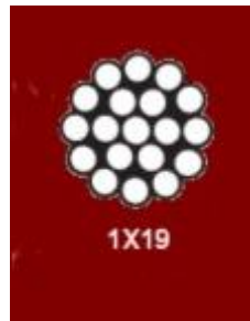
Ilustración 53. Sección de cable rígido. Fuente: CdP Jarcias
