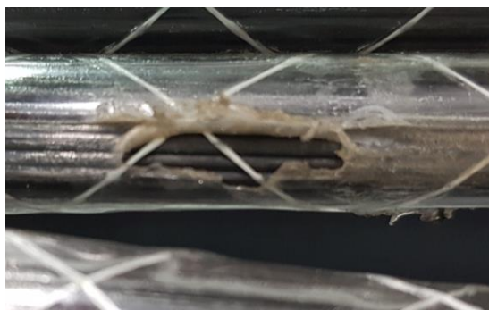
Ilustración 103. Race Film dañado. Fuente: Propia
