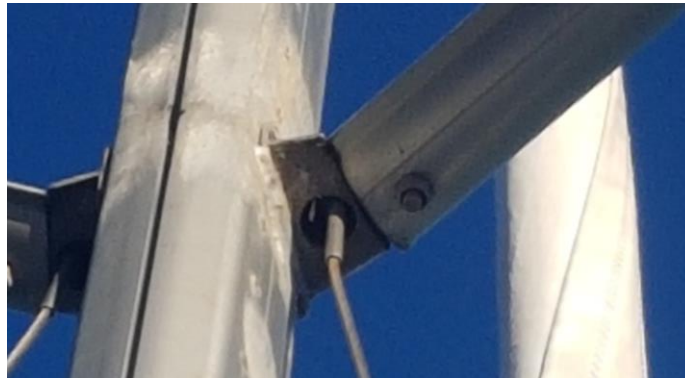
Ilustración 99. Mala alineación de la jarcia. Fuente: Propia
