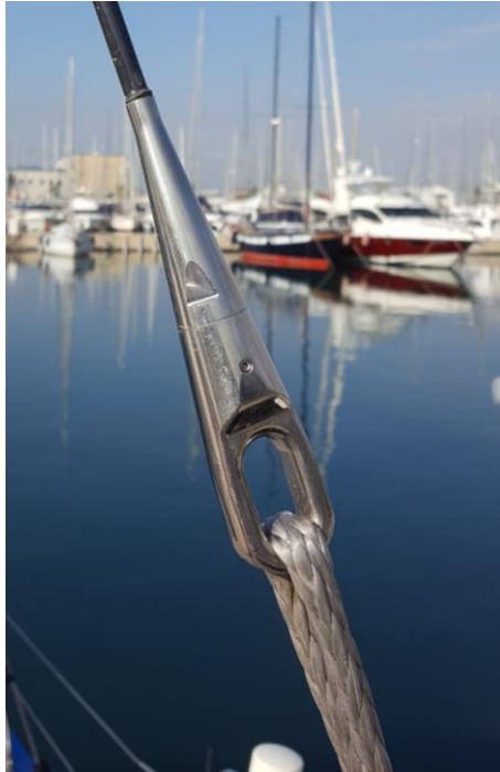
Ilustración 33. Terminal de ojo. Fuente: Propia
