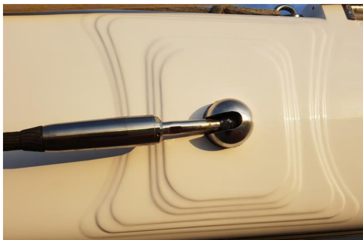
Ilustración 30. Anclaje en un palo de fibra de carbono. Fuente: Propia
