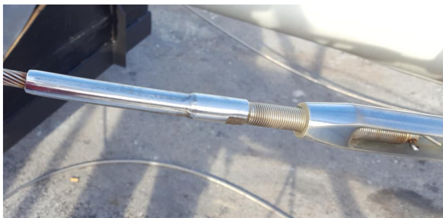
Ilustración 32. Terminal de esparrago. Fuente: Propia
