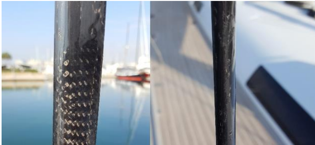
Ilustración 75. Vista de perfil y frontal de la jarcia SCR Airfoil de Hall Spars & Rigging . Fuente: Propia
