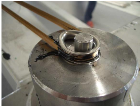
Ilustración 60. Fibras de Zylon alrededor de un terminal. Fuente: Easy Rigging
