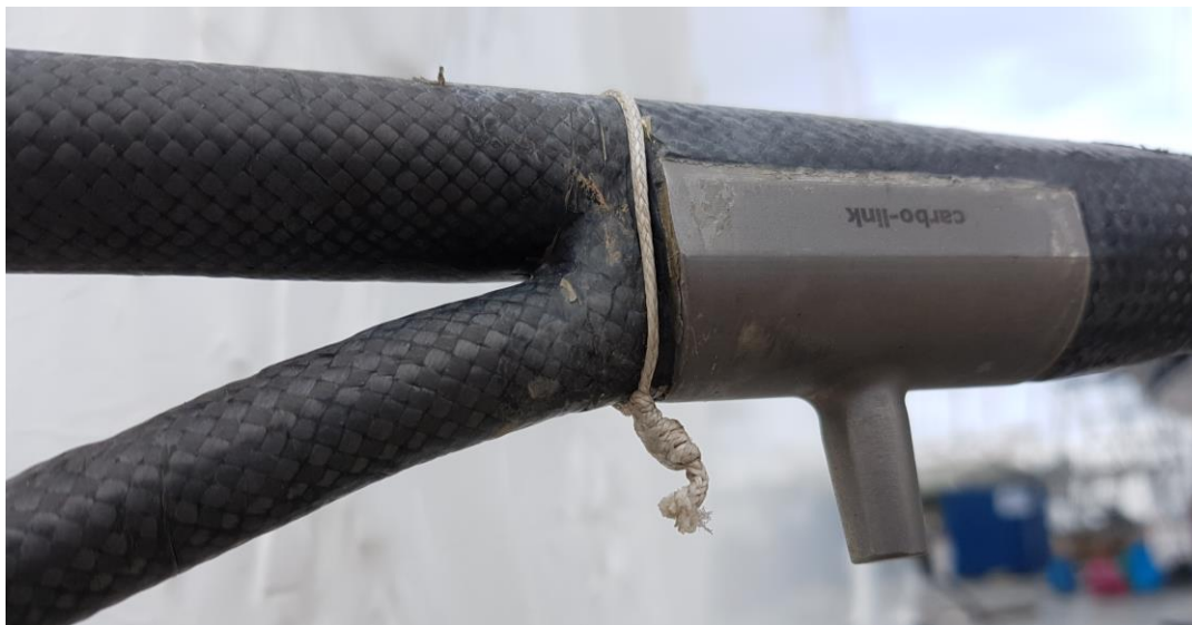
Ilustración 73. Fusión del obenque alto con el diagonal en la jarcia continua de Carbo-Link en el terminal de la cruceta. Fuente: Propia
