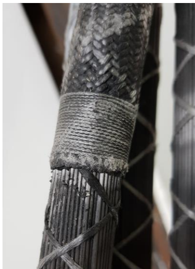
Ilustración 68. Cable de carbono composite con funda de Dyneema y sin funda. Fuente: Propia
