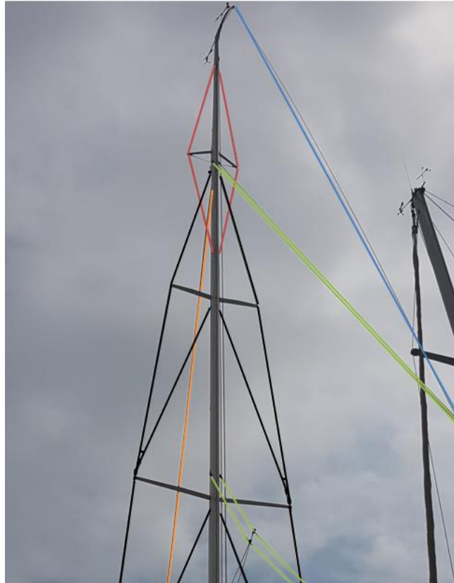
Ilustración 19. Aparejo fraccionado con crucetas rectas y violín. Fuente: Propia
