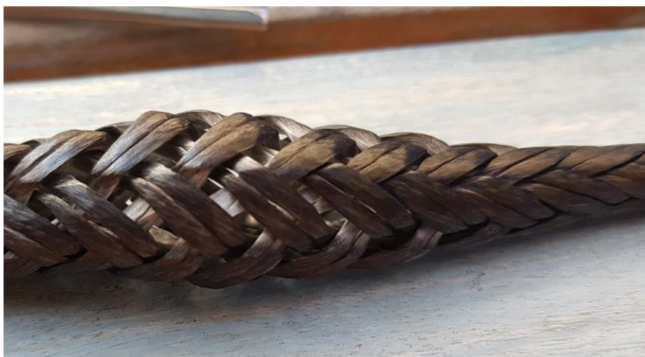
Ilustración 64. Detalle del entrelazado de un cabo de Dyneema SK75. Fuente: Propia
