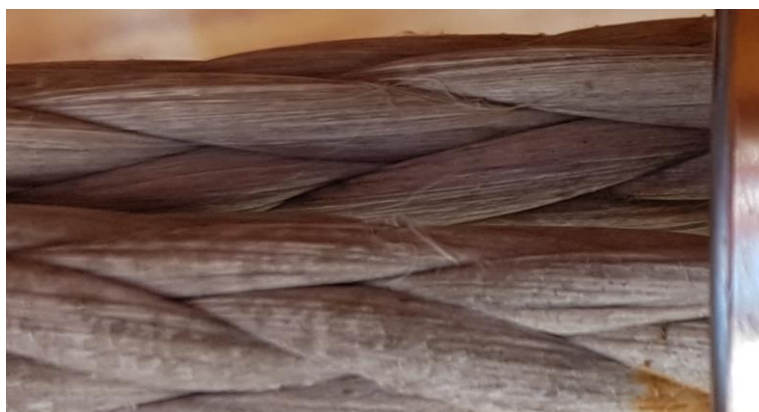
Ilustración 63. Detalle de fibras paralelas, cabo de Dyneema. Fuente: Propia
