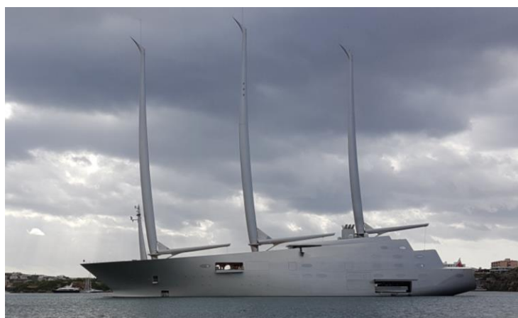
Ilustración 6. Palos sin jarcia transversal. Fuente: Propia
