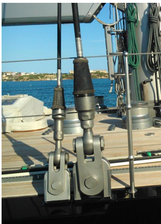
Ilustración 38. Tensor fijo. Fuente: Propia
