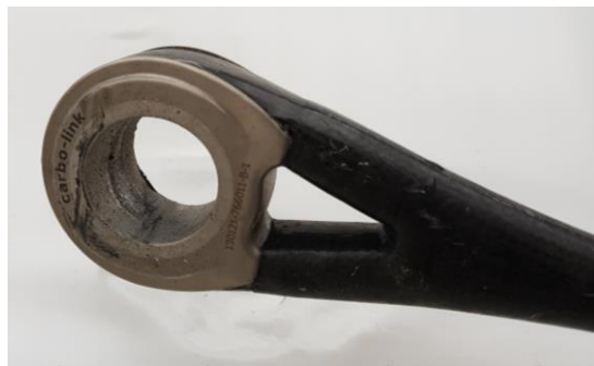
Ilustración 105. Terminal de ojo en jarcia de Carbo-Link . Fuente: Propia
