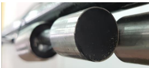
Ilustración 108. Cabeza del terminal, cable de carbono compacto. Fuente: Propia
