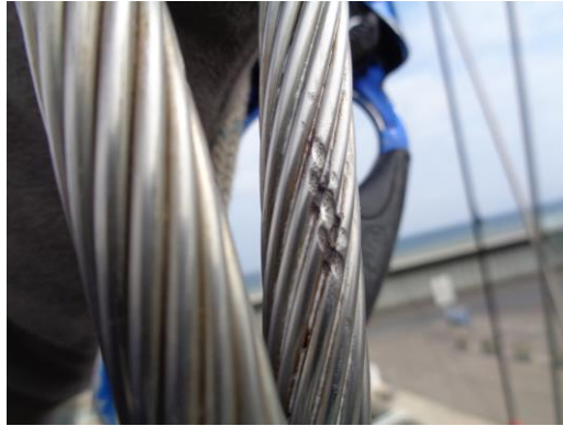
Ilustración 88. Abrasión en el cable rígido de un diamante. Fuente: Propia
