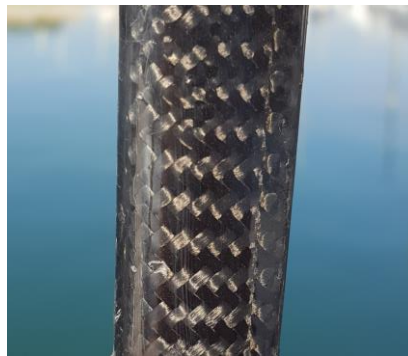
Ilustración 109. Fibras biaxiales, cable de carbono compacto. Fuente: Propia
