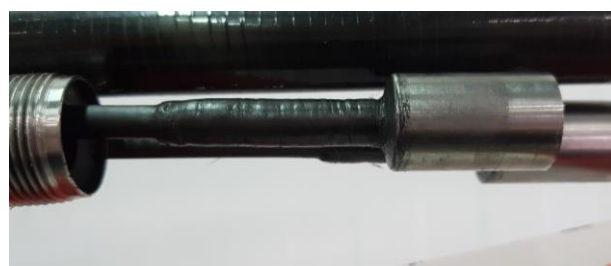
Ilustración 106. Terminal de Future Fibres con rosca para el interior del palo. Fuente: Propia
