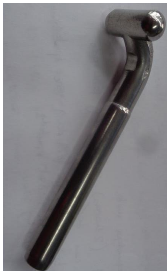
Ilustración 35. Terminal en T. Fuente: Propia
