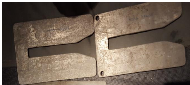
Ilustración 45. Placas para elevar el palo. Fuente: Propia
