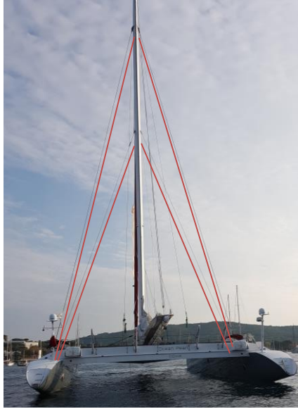
Ilustración 8. Palo de multicasco sin crucetas. Fuente: Propia
