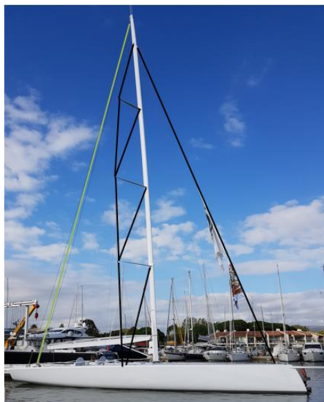
Ilustración 18. Aparejo fraccionado a 7/8 con crucetas retrasadas. Fuente: Propia
