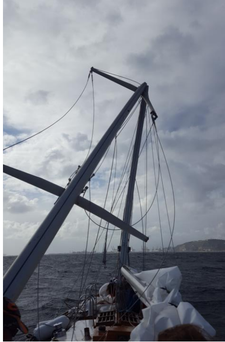
Ilustración 117. Velero clásico desarbolado tras rotura de cadenote. Fuente: Propia
