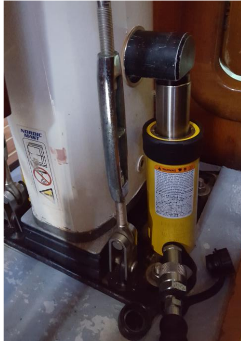
Ilustración 43. Cilindro hidráulico a estribor del palo. Fuente: Propia
