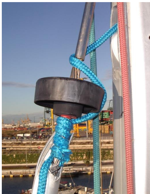
Ilustración 93. Driza enrollada en el estay. Fuente: Propia
