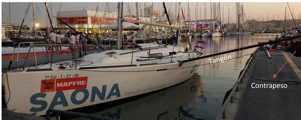
Ilustración 59. Medición de estabilidad. Fuente: Propia
