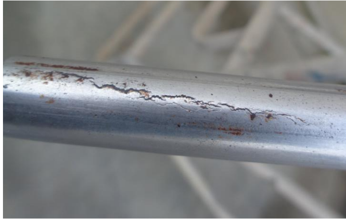
Ilustración 96. Grietas longitudinales en jarcia de Varilla. Fuente: Propia
