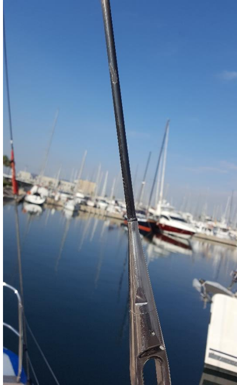
Ilustración 74. Backstay de SCR. Fuente: Propia
