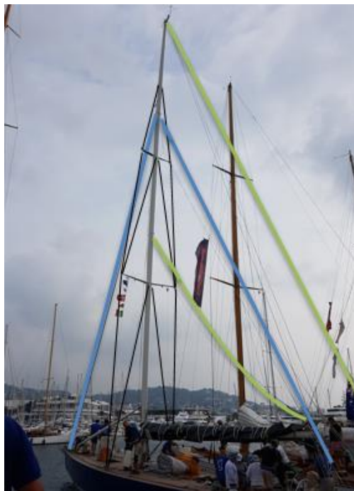
Ilustración 16. Vista desde la aleta de babor de un aparejo fraccionado a 3/4. Fuente: Propia
