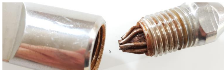
Ilustración 85. Interior del terminal manual con cono. Fuente: Propia
