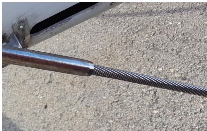
Ilustración 52. Cable rígido. Fuente: Propia
