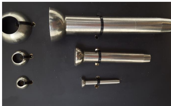
Ilustración 34. Terminales de bolas. Fuente: Propia
