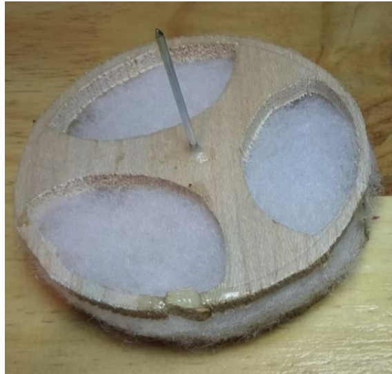
Ilustración 2-2. Regenerador ubicado en el interior de un pistón desplazador
