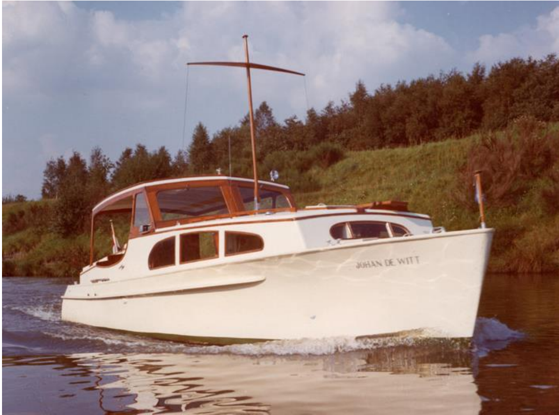
Ilustración 6-2. Yate con motor Stirling “Johan de Witt” 10
