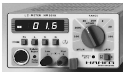
Figura 4.3. Medidor LC HM8018 HAMEG (Fuente: [20])
