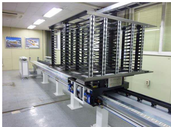
Figura 3.6. Sistema maglev cinta transportadora (Fuente:[8])
