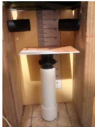
Figura 4.6. A la izquierda está el emisor de infrarrojos y a la derecha el fototransistor (Fuente: Propia)
