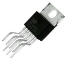
Figura 4.9. Amplificador de potencia OPA548 (Fuente: [23])
