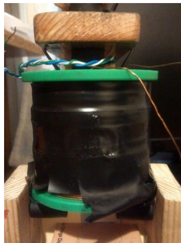
Figura 4.2. Electroimán diseñado (Fuente: Propia)
