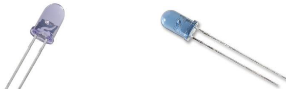
Figura 4.7. Fototransistor BPW40 (izquierda) y emisor IR TSAL6200 (derecha) (Fuente:[21][22])
