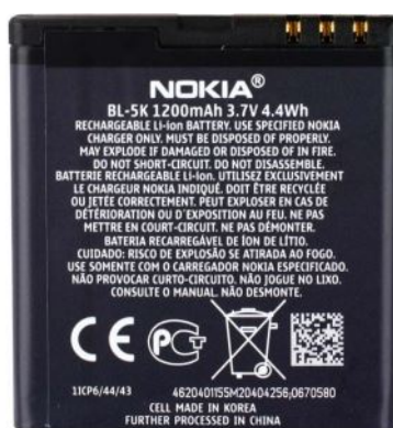
Figura 4.4. 1-1 Veiem que la bateria disposa de 3 entrades. Començant per la dreta: Alimentació positiva, terra i sensor de temperatura.
