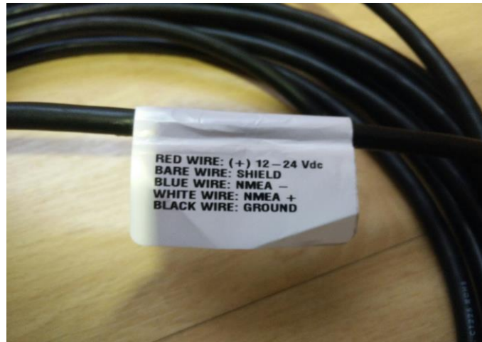
Fig. 2.4.1.2 Información cableado NMEA
