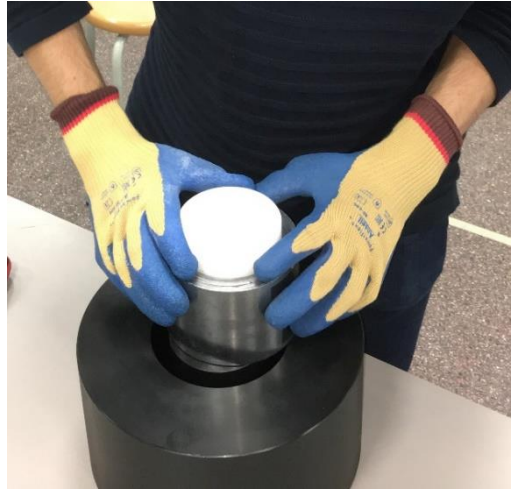
Figura 5.9. Ensamblaje del moderador y el conversor (plomo).
