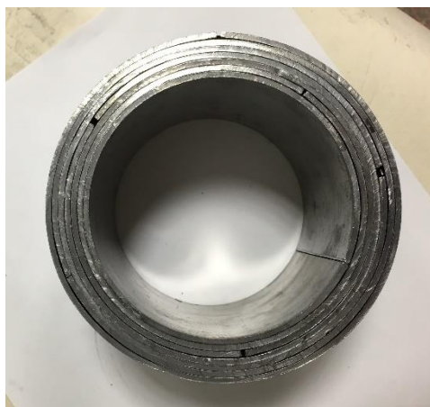
Figura 5.8. Pieza con los siete cilindros de plomo enrollados. 1,4 cm de ancho.
