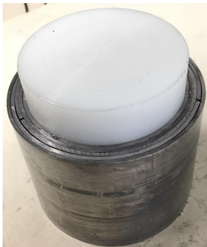
Figura 5.7. Planchas de plomo enrolladas en el cilindro de \varnothing 86 mm.
