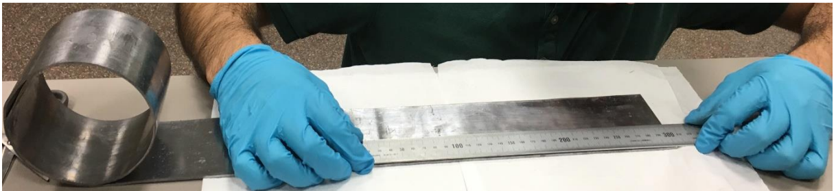
Figura 5.5. Medir y marcar la longitud de plomo necesaria.
