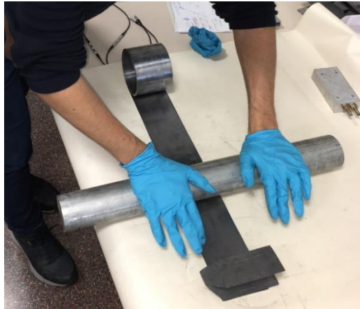
Figura 5.4. Aplanamiento plancha de plomo.
