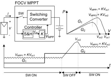
Fig. 2. FOCV control technique.
