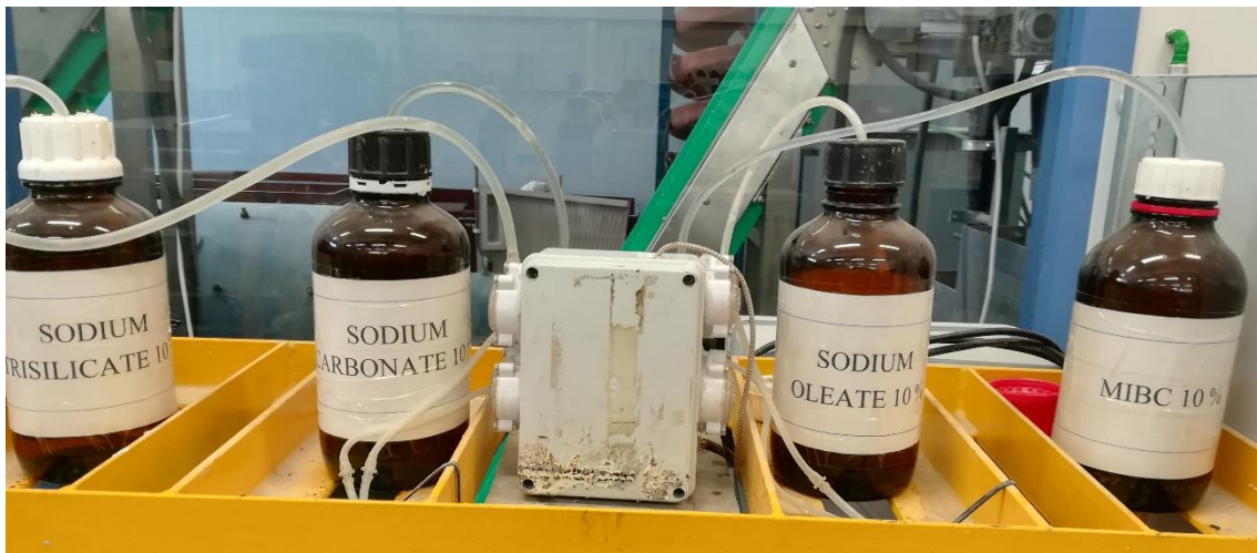
Ilustración 43: Dosificación de material químico
