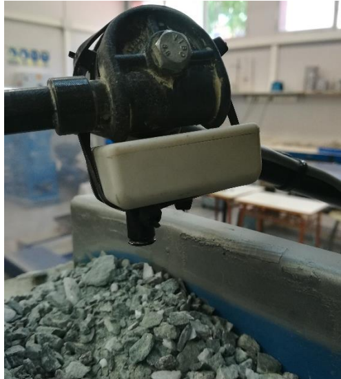
Ilustración 30: Montaje del sensor de temperatura de entrada.
