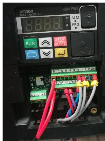
Ilustración 32: Conexión del variador con el Arduino
