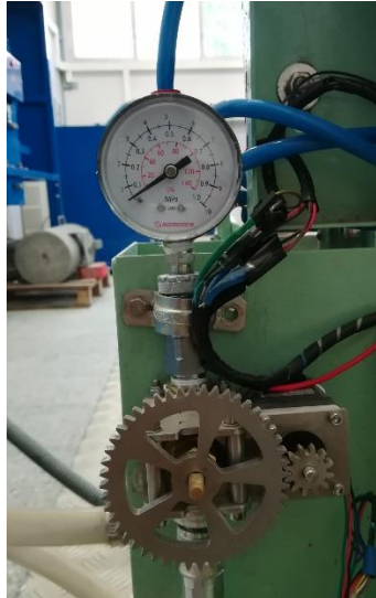
Ilustración 45: Mecanismo de engranajes para rotar la válvula del sistema de aire
