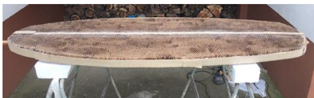
Fig. 9: Núcleo después del proceso de shapeado
