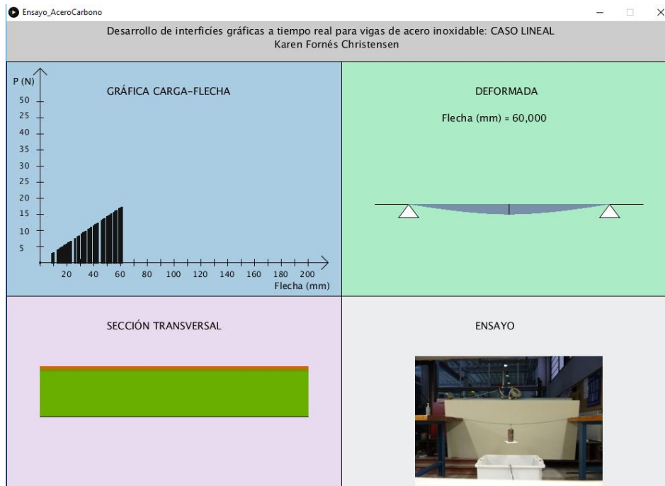
Fig.5.1.3. 2. Muestra del escalón 6, con 2.08 Kg y flecha de 60 mm
