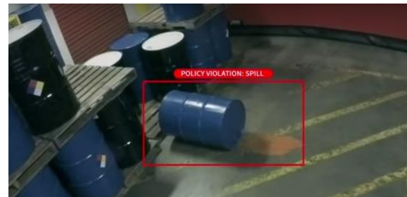
Fig. 2.3.2. Ejemplo de aviso de vertido peligroso vía detección de cámaras y aviso a teléfono móvil [14]
