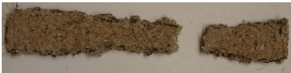
Figura 26. Proveta tracció trencada
