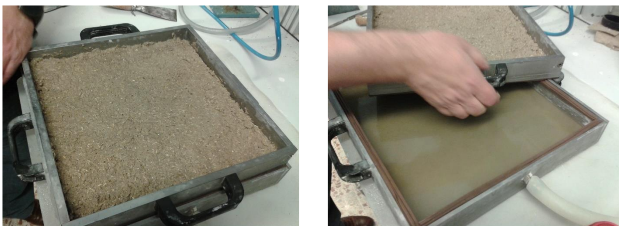
Figura 18 i 19. Procés fabricació placa hidromulch amb el motlle 1 i 2
