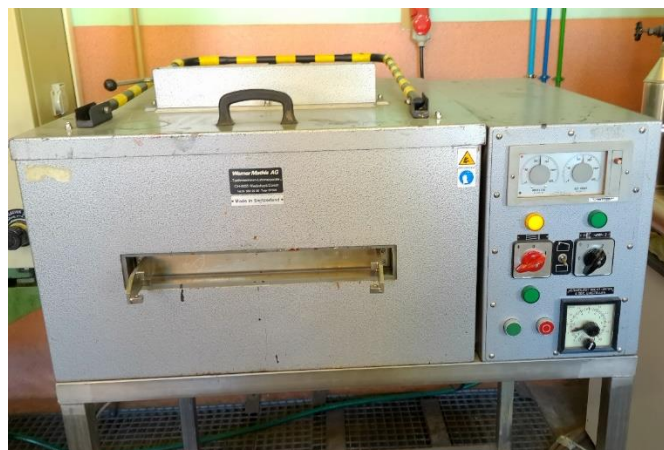
Fig. 14: Rame utilitzada per assecar els teixits.
