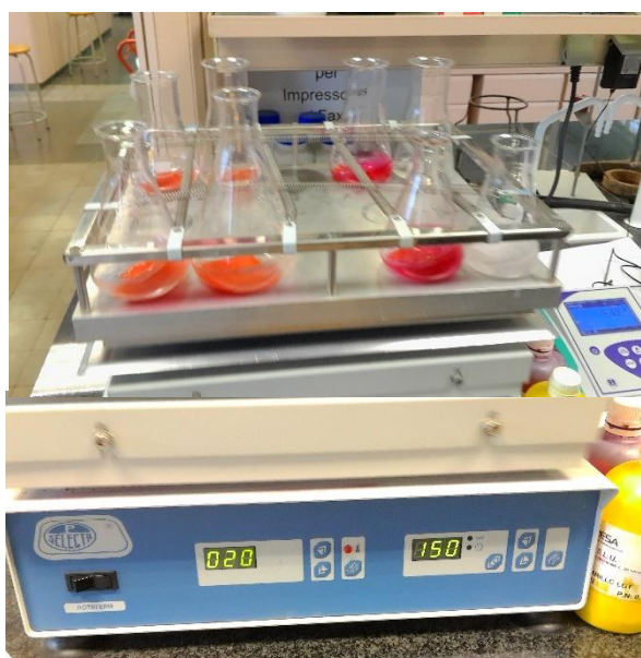
Fig. 19: Agitador orbital utilitzat en l'eliminació del cotó.
