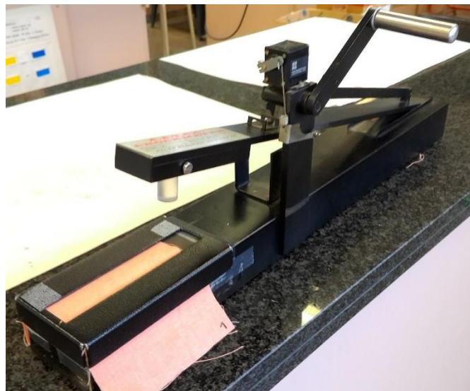
Fig. 20: Crockmeter utilitzar per mesurar les solideses.
