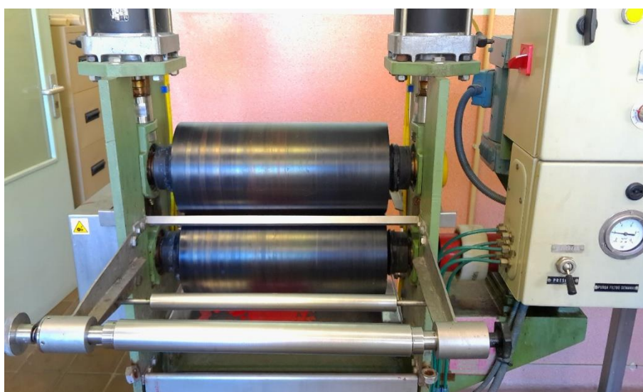
Fig. 12: Unitat de foulardat utilitzada en l'operació d'impregnació.
