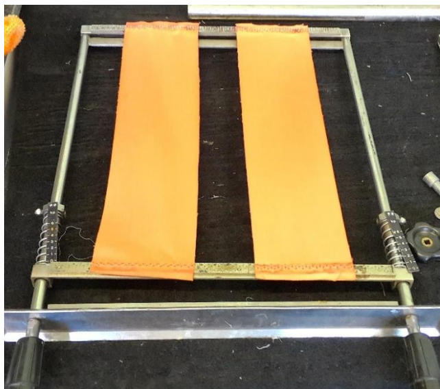
Fig. 13: Col·locació de les mostres en el marc d'agulles per l'operació d'assecat.
