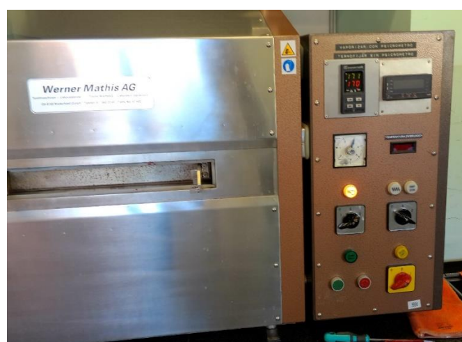
Fig. 15: Rame utilitzada per realitzar el procés thermosol.
