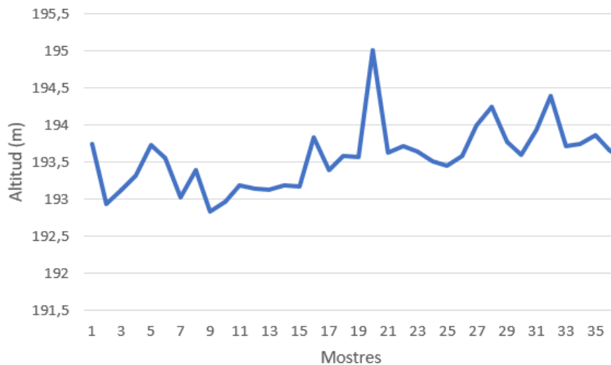
Figura 37: Gràfica de l'altitud obtinguda amb un filtre de mitja mòbil de 8 segons de finestra.
