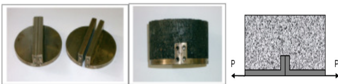
Figura 2.4 Bases de la probeta, probeta para el ensayo y esquema del ensayo. Fuente (ETSECCPB)
