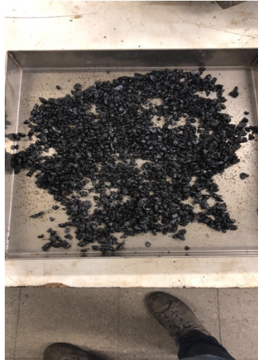
Figura 3.9 Desgranado de la mezcla
