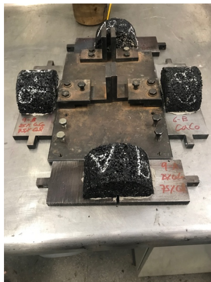
Figura 3.14 Probetas adheridas a las placas
