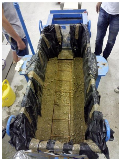
Figura 2.2.1 Situació del reforç dins de la caixa d'assaig.
