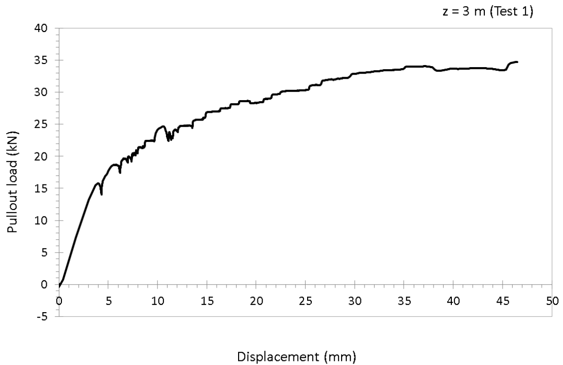
Figura A.1.3. Resultats de l'esforç d'extracció respecte al desplaçament del reforç per a z = 3 m de confinament. Força d'extracció a 25mm = 30,33 kN
