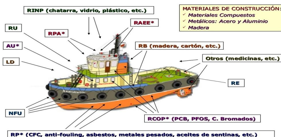
Figura 53: Ubicación de los residuos peligrosos. (Gestión de los buques al final de su ciclo de vida, Rafael Acedo)
