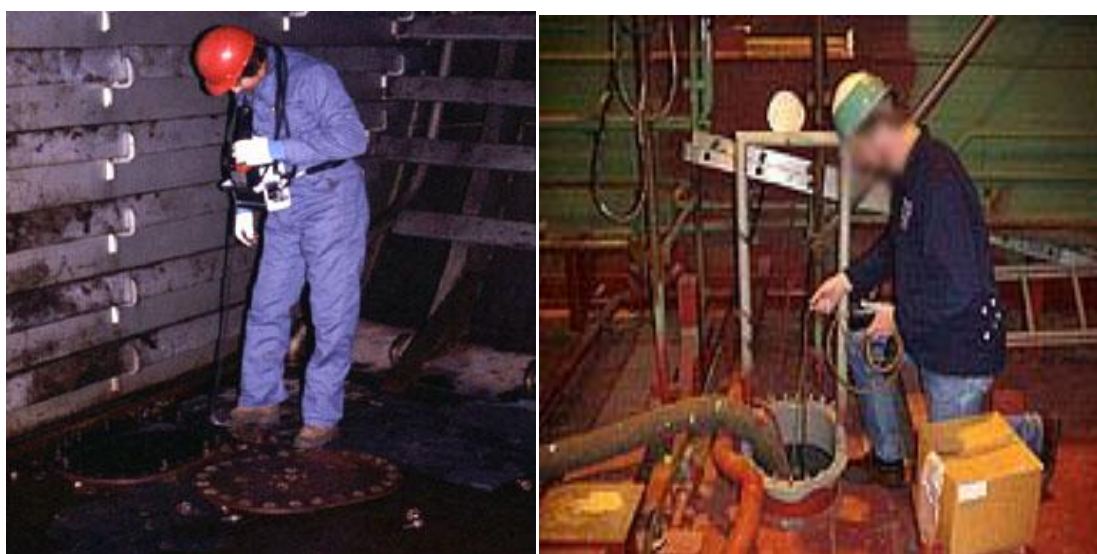
Figura 49: Trabajadores realizando pruebas atmosféricas para Entrada Segura. (www.osha.gov)
