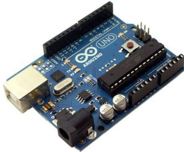
Figura 5.5: Placa Arduino UNO basada en el microcontrolador ATmega328P 10
