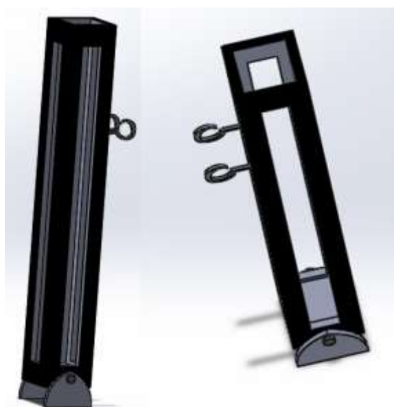
Figura 10.2.4. Guia articulada de la peça encarregada d'empènyer la trapa (figura 10.2.3). Font: Pròpia
