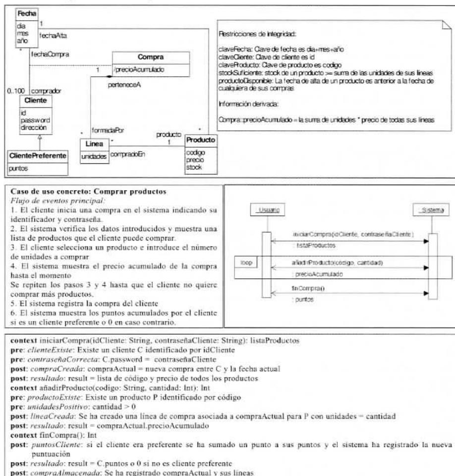
Fig. 6. Especificación del ejemplo del e-supermercado: modelo conceptual; caso de uso concreto; diagrama de secuencia correspondiente al caso de uso; contratos de las operaciones.
