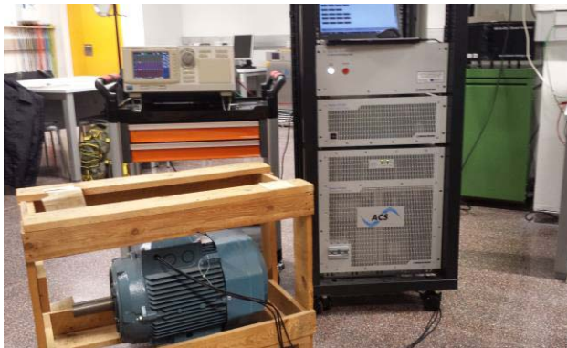
Fig. 10. Ensayo del emulador de redes Regatron TopCon TC.ACS.30.480.400.S.LC, en este caso habiéndose programado un régimen de arranque para un motor sincrónico de 5,5 kVA. Pueden apreciarse, entre otros componentes del ensayo, el emulador de red (bloque inferior), el sistema de disipación y las bobinas de absorción (bloque superior).
