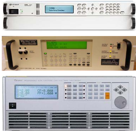
Fig. 4. De arriba a abajo: Emulador de campo fotovoltaico (E3460 de 1,2 kWp), emulador de red (112AMX, 1,2 kW) y carga electrónica CC y CA programable (63802, de 1,8 kW).
