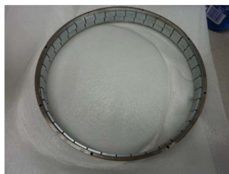
Figura 6. Rotor del generador desarrollado.
