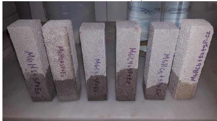
Probetas al finalizar la prueba de absorción por capilaridad - Ilustración 35 Fuente: elaboración propia
