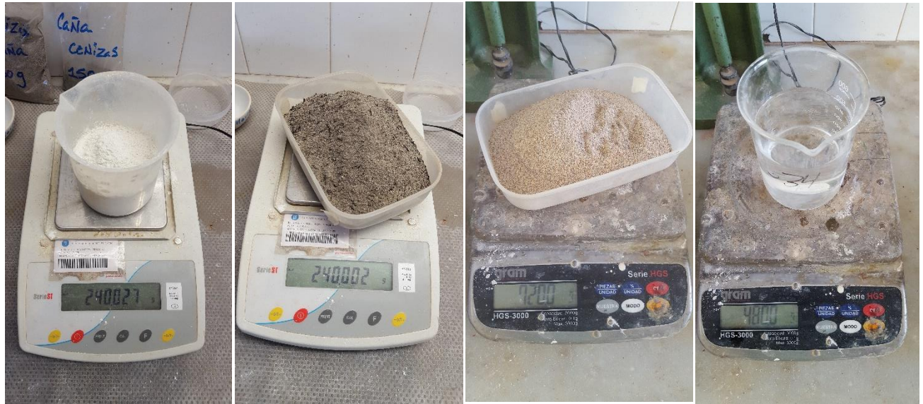
Control de los diferentes ingredientes para la preparación de la mezcla - Ilustración 28 Fuente: elaboración propia
