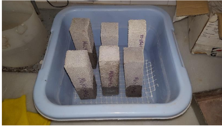
Prueba de absorción por capilaridad - Ilustración 34 Fuente: elaboración propia
