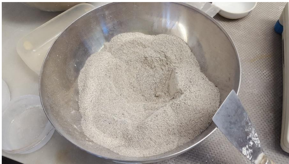
Mezcla de las cenizas con el árido y el conglomerante - Ilustración 29 Fuente: elaboración propia
