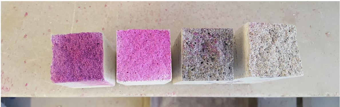
Comparación de probetas carbonatadas y no carbonatadas - Ilustración 56
