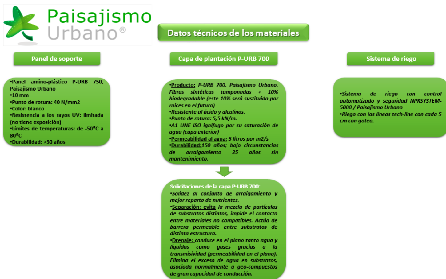
Figura 29. Datos técnicos de los materiales en el Sistema F+P de Paisajismo Urbano
