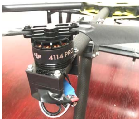
Figura 5.1.3. Fotografia de la unió de les hèlices amb el motor. Font: Font pròpia.
