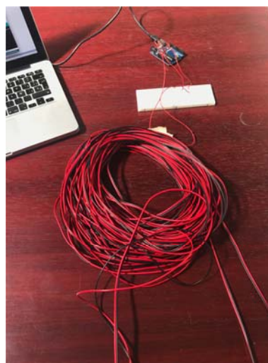
Figura 6.4.2. Fotografia del cable bobinat amb un diàmetre interior de 10cm.
