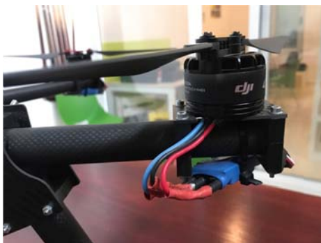
Figura 5.1.2. Fotografia de la unió del motor amb la xapa de carboni i amb el braç del dron. Font: Font pròpia.
