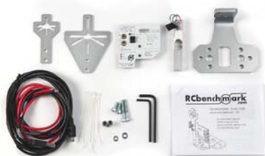
Figura 6.5. Banc de motors desmuntat.
