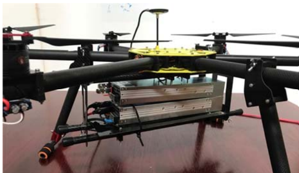
Figura 5.5.11. Fotografia del suport dels convertidors, vista lateral. Font: Font pròpia
