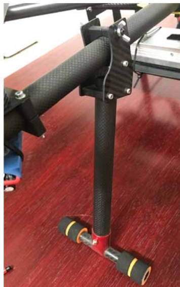
Figura 5.5.10. Fotografia de la pota del dron on s'hi pot veure els complements d'espuma a la part inferior. Font: Font pròpia.
