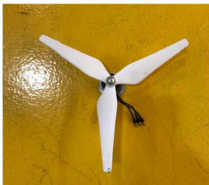
Figura 6.3.2. Fotografia del motor MT2216 amb les hèlices de 3 pales instal·lada. Font: Font pròpia.
