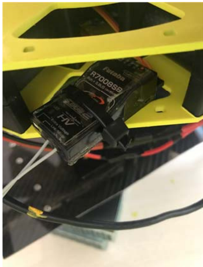
Figura 5.7.3. Fotografia la unió del receptor amb el xassís. Font: Font pròpia.
