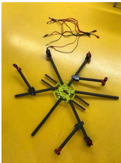
Figura 5.5.6. Fotografia de l'estructura del dron juntament amb el cablejat de potència que alimenta els variadors. Font: Font pròpia.
