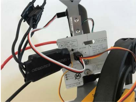
Figura 6.7. Muntatge del variador al banc de motors. Font: Font pròpia
