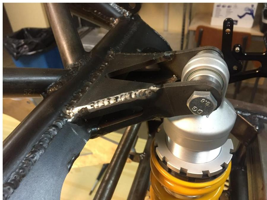
Figura 9.4 – Imatge la fixació superior del xassís amb l'amortidor.
