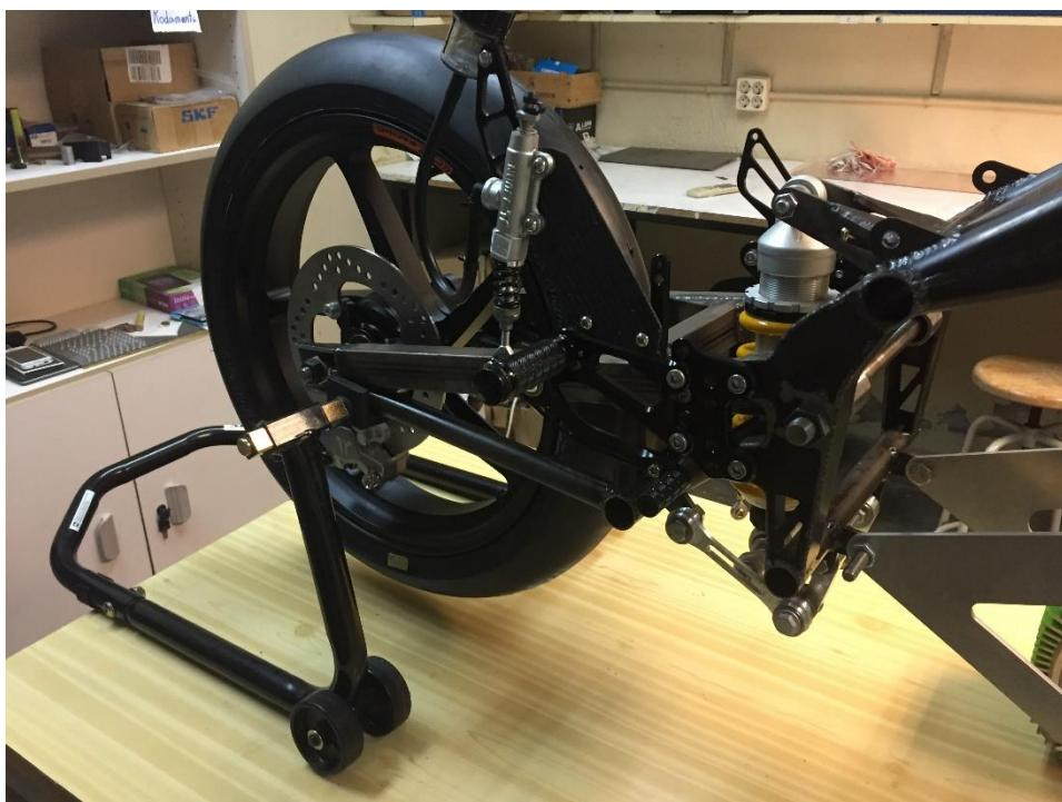
Figura 9.6 – Imatge del tren posterior muntat amb el joc d'estriberes i frens del prototip e-One
