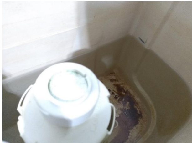
Il·lustració 31: Marques realitzades conforme nivell d'aigua inicial. (Font: Elaboració pròpia)
