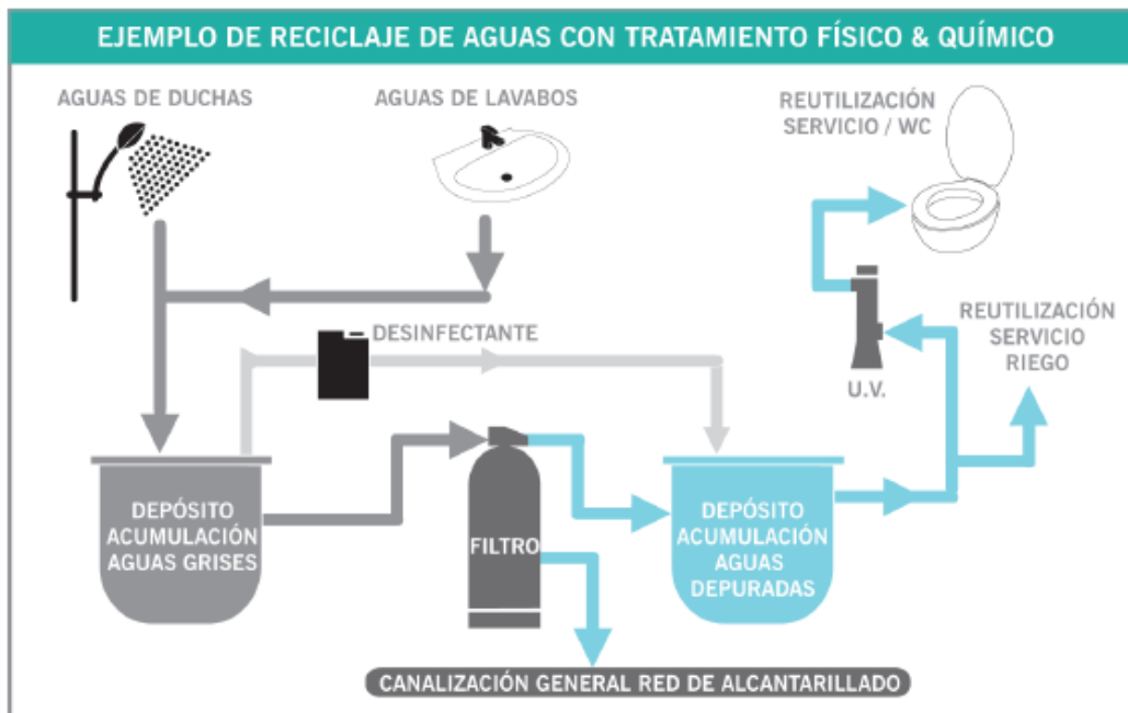
Il·lustració 27: Esquema funcionament tractament físic-químic d'aigües grises. (Font: AQUA España)
