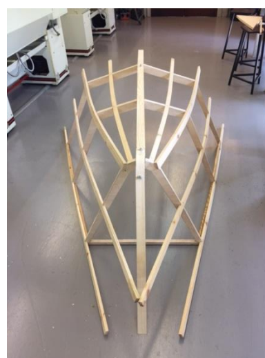
Figura 101. Estructura interna de la embarcación
