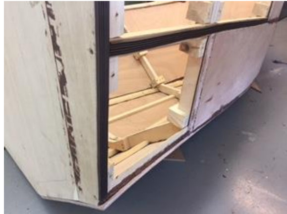
Figura 113. Tira de caucho en la unión longitudinal
