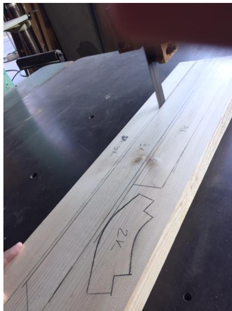
Figura 91. Proceso de corte de la quilla y roda
