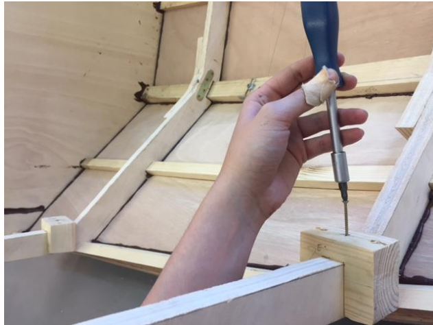
Figura 107. Atornillado de los dados a las cuadernas
