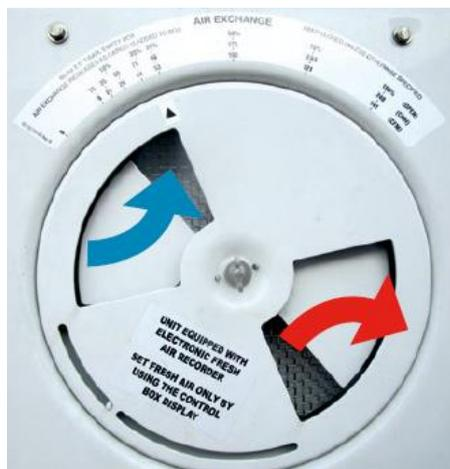
Los contenedores de Hamburg Süd pueden ventilar un volumen de aire a la hora dentro de un rango de entre 0 y 285 cbm/h.
