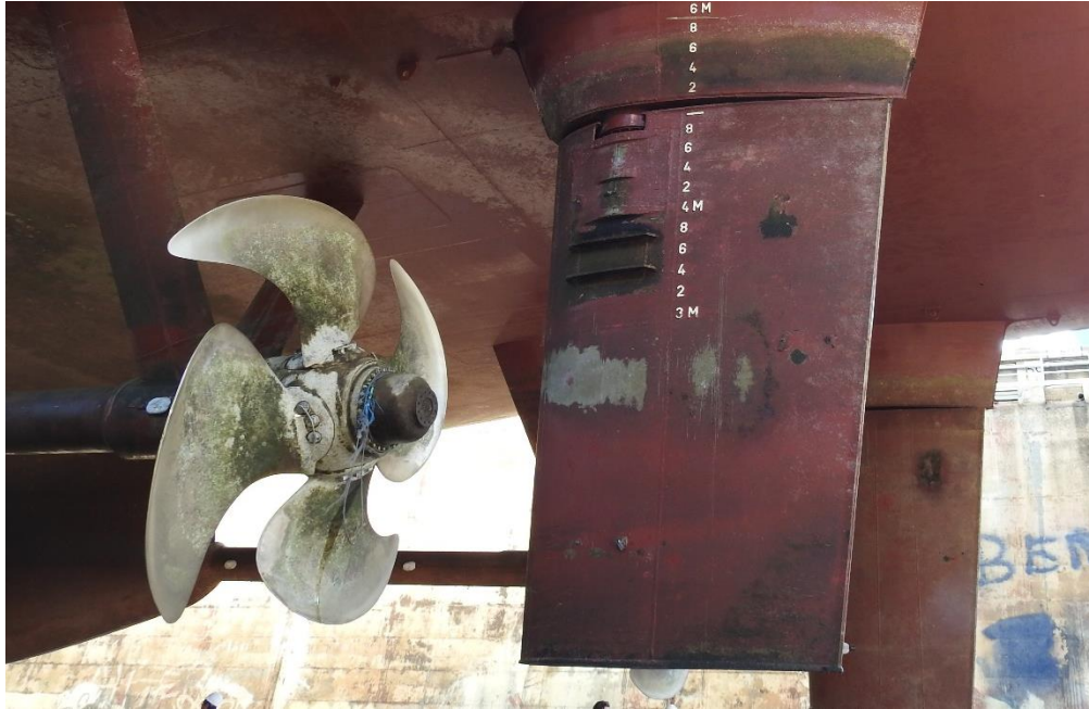
Ilustración 2. Hélice de paso variable de babor, en la varada hecha en 2016 en Marsella. Fuente propia.
