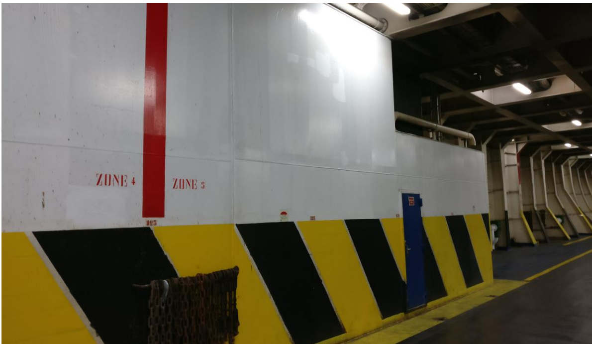
Ilustración 32. En el garaje hay líneas rojas para señalar donde termina una sección y empieza otra. Fuente propia.
