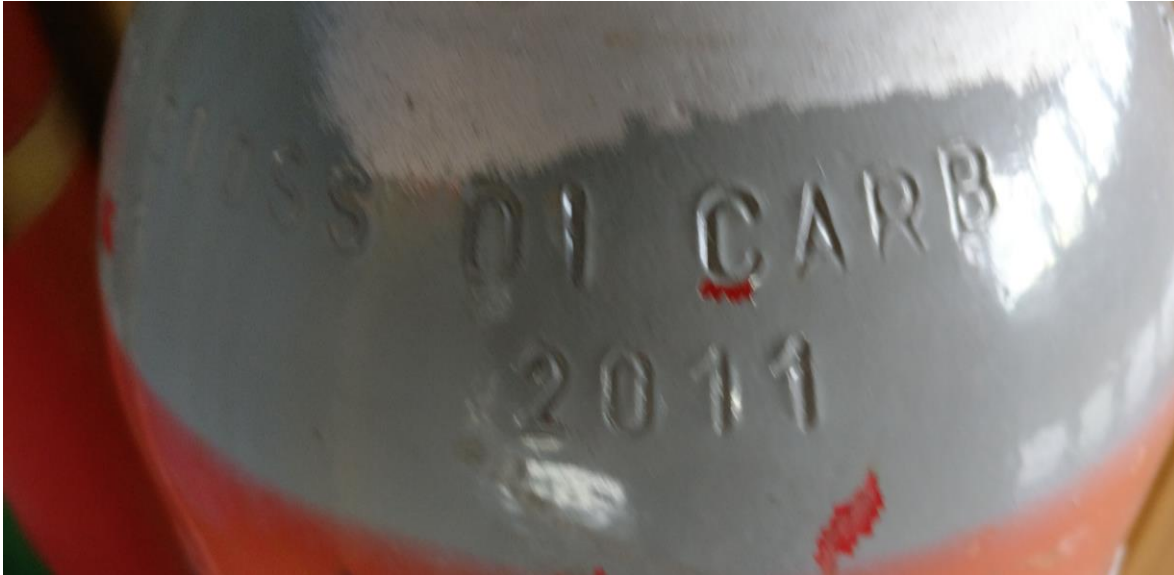
Il·lustració 45. El año en que se ha hecho el test hidrostático se troquela en el extintor. Fuente propia.
