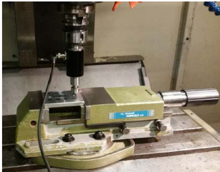
Figura 19 Procés de brunyit amb bola en una fresadora CNC.
