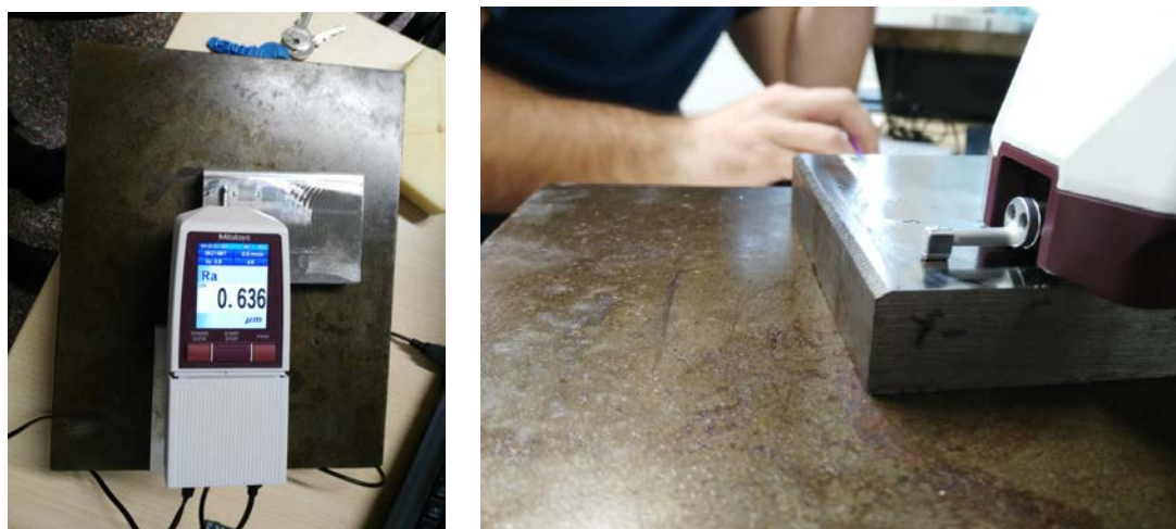
Figura 24 Mesura de la rugositat amb MITUTOYO SJ210.
